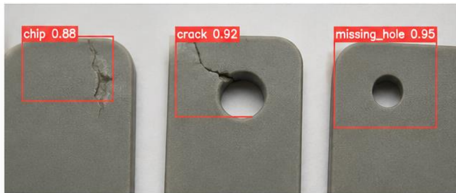
Рис. 8 - Пример локализации дефектов системой YOLOv8n
