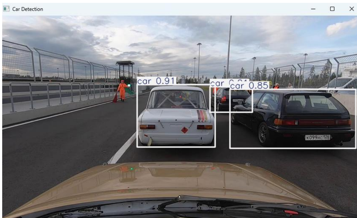
Рисунок 4. Пример детекции автомобилей на тестовом изображении
