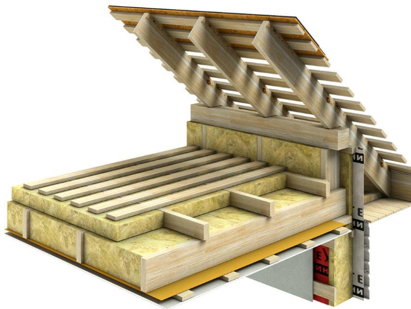
Рисунок 3. Пример Теплоизоляции чердачного перекрытия
