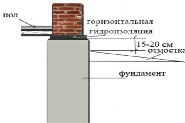
Рисунок 4 –Изоляция между цоколем и основной стеной
